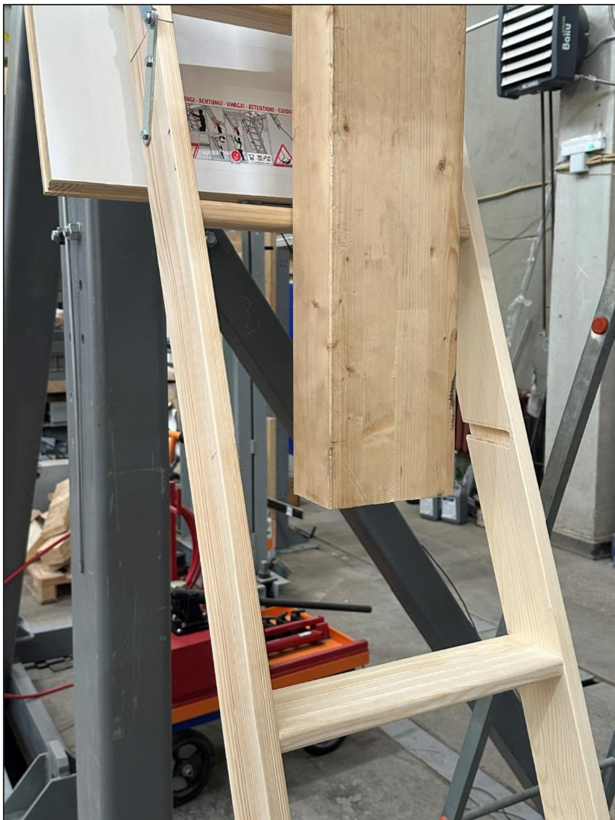
Рисунок 5 – характер разрушения образца №2
