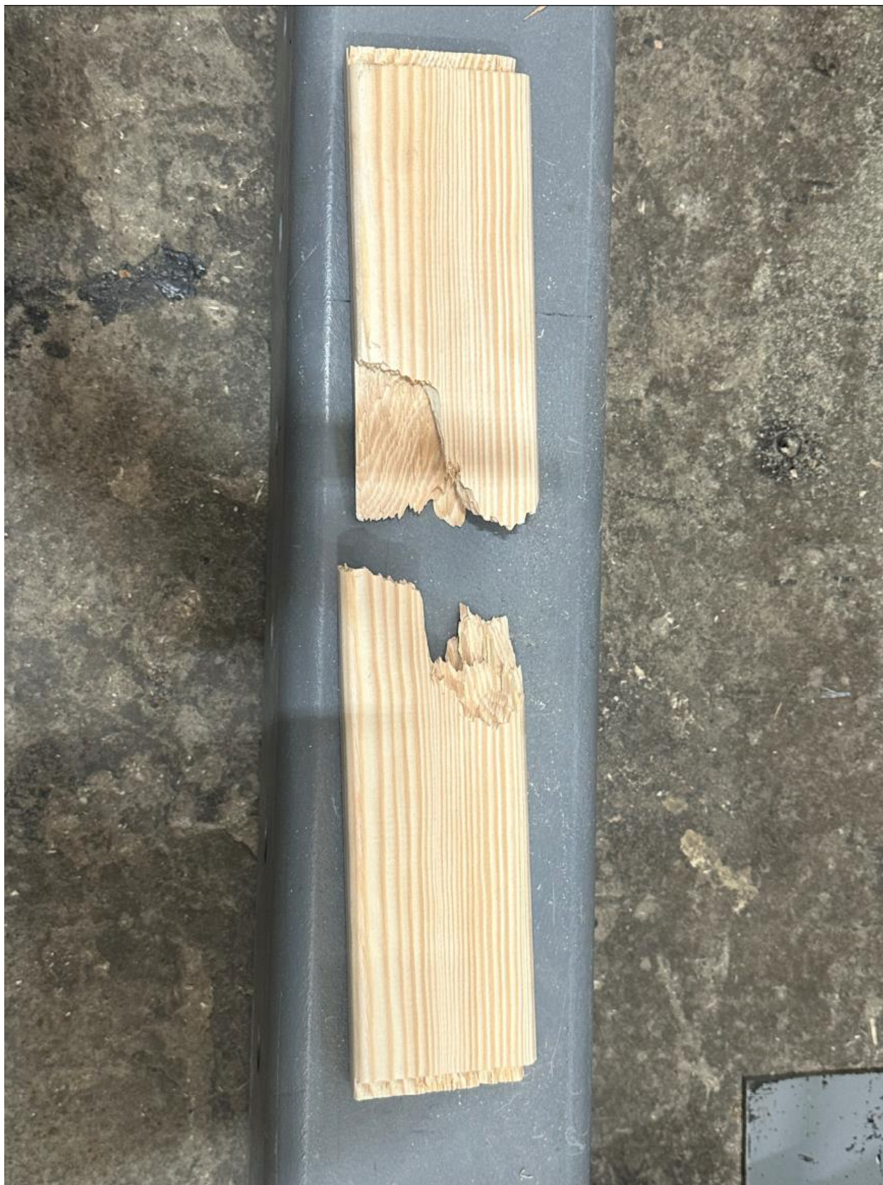
Рисунок 6 – Вид разрушения ступени
